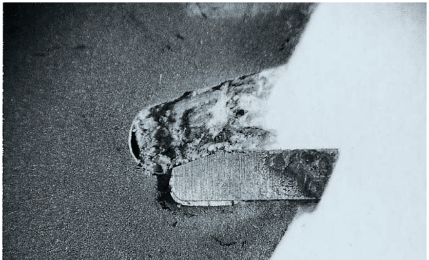
Schneidenzerstörung durch Fehleinsatz.
