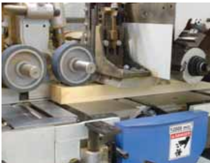
Detailansicht einer Vierseitenhobel- und Profiliemaschine mit Rollenvorschub.
