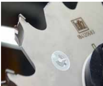
Werkzeug mit NFC Chip
