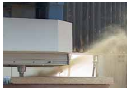
DFC®-Oberfräser: Spänestrahл wird nach oben zur Absaugung hin gelenkt und kann abgesaugt werden.
