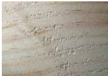
Fertig gehobelte Oberfläche nach konventionellem Vorhobeln.
