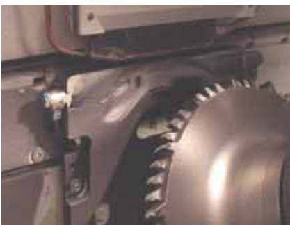
Problem: Maschinenverschleiß durch abrasive Späne.
