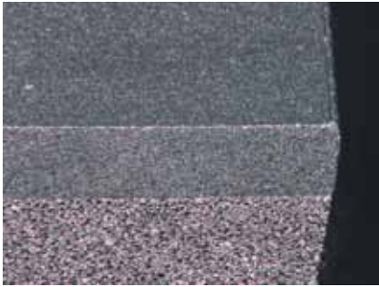
Schneide aus DP – polykristalline Diamantschicht (oben) aufgesintert auf Hartmetall-Substrat (unten)
