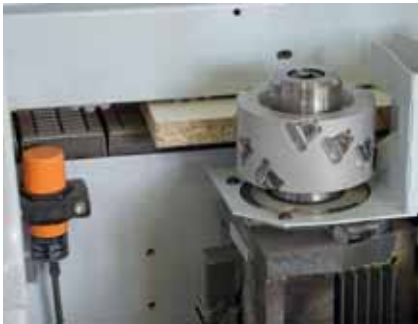
Detailansicht einer Kantenanleim- maschine mit Kettenvorschub.
