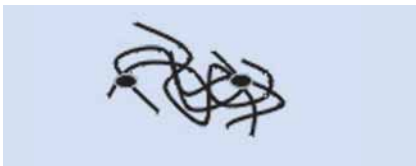
Struktur von Elastomeren (Prinzipdarstellung)
