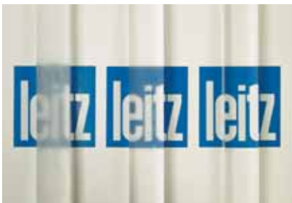
Glanzgefräste Fläche an PMMA-Werkstück
