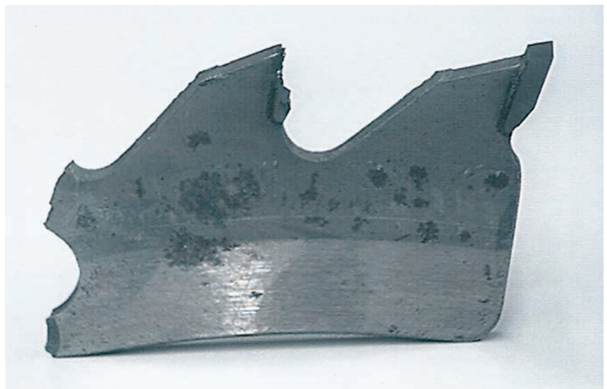
Détérioration de la coupe due à une sollicitation trop importante.
