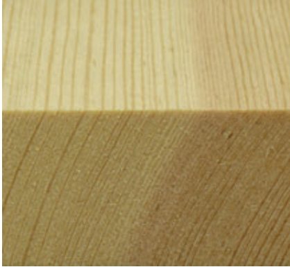
Aubier (clair) et bois parfait (foncé) (Exemple pin)
