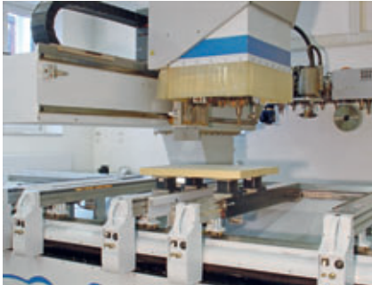
Centre d'usinage à col de signe et table à console.
