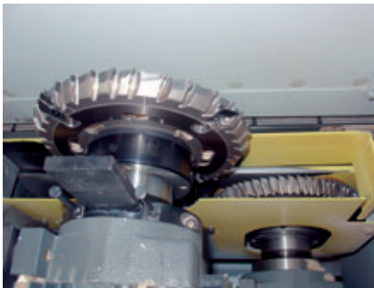
Déchetageur DFC® avec coupes supplémentaires spéciales qui réduisent le dépassement de placage à des tailles de copeaux pouvant être aspirées. Il ne reste plus aucun résidu.
