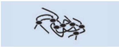
Structure des Duroplastiques (schéma de principe)
