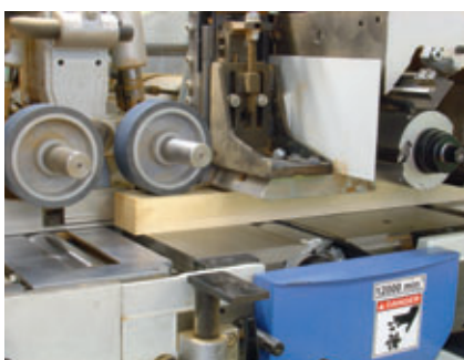
Vue détaillée d'une raboteuse 4 faces et d'une moulurière à entraînement à rouleaux.
