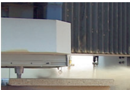
Défonçage de plans de travail avec une mèche DP conventionnelle. Le flux des copeaux est horizontal et traverse les brosses ou les lamelles de protection.
