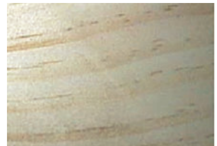
Rabotage de finition suite au rabotage d'ébauche avec un outil RipTec.
