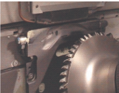
Problème : usure de la machine due à des copeaux abrasifs.
