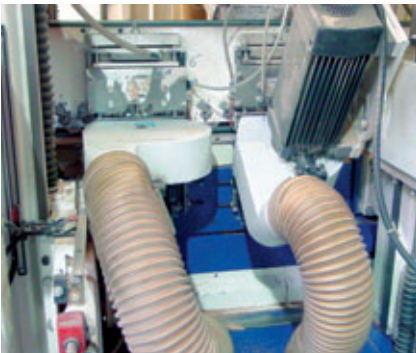
Problème : usure de la machine due à des copeaux abrasifs.
