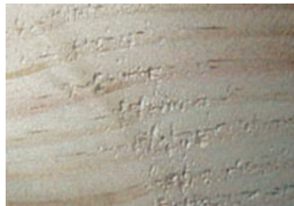
Rabotage de finition à l'aide d'un outil conventionnel.
