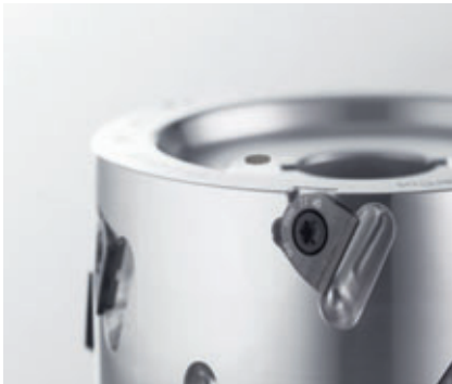
Outil avec Chip RFID
