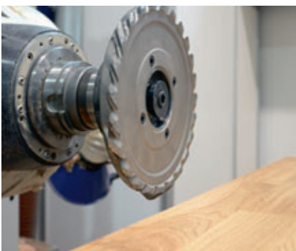
Outil DFC® permettant l'orientation du flux de copeaux. Système DFC® : outil avec capot d'aspiration adapté. Une majeure partie des copeaux est ainsi captée et l'usure de la machine considérablement réduit.
