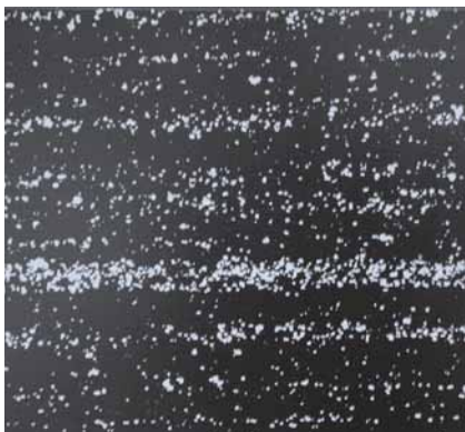
Structure linéaire de l'acier rapide HS issu des techniques de fusion
