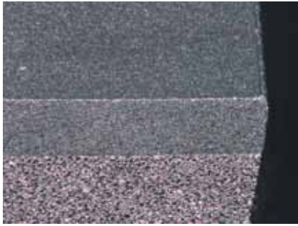
Arête de coupe DP – Couche de diamant polycristallin (haut) fritté sur un substrat de carbure (bas)
