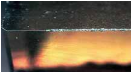
Arête de coupe en DM – Diamant monocristallin synthétique
