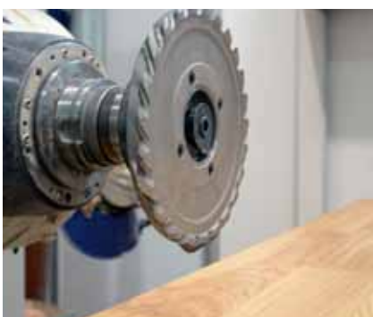
DFC®-gereedschap voor gerichte spanenstraal. DFC®-systeem: gereedschap met aangepaste afzuigkap. Het grootste deel van de spanen wordt opvangen en weggehouden bij de slijtage van de machine.
