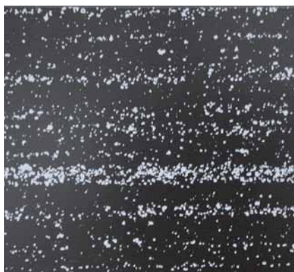
Lijnvormige structuur bij smelttechnisch geproduceerd HS-staal
