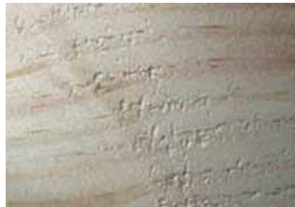
Geschaafde oppervlaktes na conventioneel voorschaven
