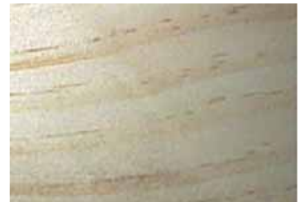
Geschaafde oppervlaktes na voorschaven met RipTec
