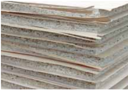
Voorbeeld: verspanen gefineerde platen met een vrije fineeroverstand.
